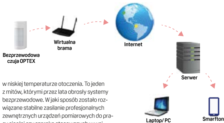
Rys. 3. Bezprzewodowa transmisja danych w czujkach OPTEX z wykorzystaniem IoT
